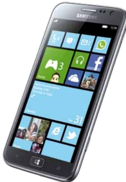
AMOLED pour une résolution de 1280 x 720 pixels, un capteur de 8 mégapixels rétroéclairé avec flash LED, le Bluetooth, le WiFi, une puce NFC, 2 Go de mémoire vive, et un SoC quadruple coeur cadencé à 1.6 GHz. Il est un tout petit peu plus lourd que le Note (180g contre 178g) et un peu plus fin (9.4 mm contre 9.6 mm).
